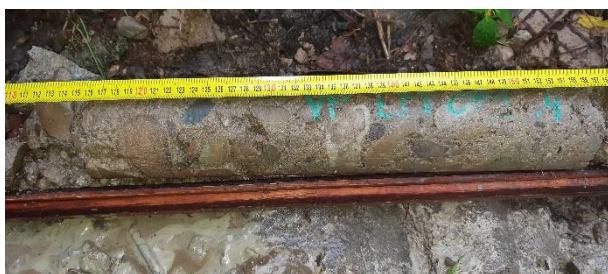
120-150, beton opěry, poměrně dobrý stav,
