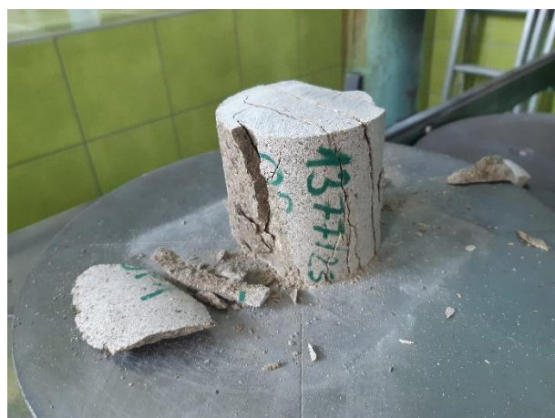
Pohled na porušený vzorek kamene V1.1 při hodnotě krychelné pevnosti 62,0 MPa.
