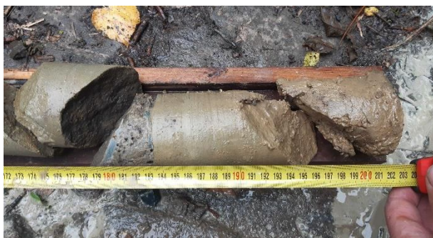
170-200 cm, pískovcový kámen, viditelný spojovací ložný beton, konec opěry, celková tl. 200 cm.
