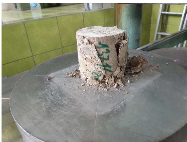
Pohled na porušený vzorek betonu opěry 1371/25 při hodnotě krychelné pevnosti 15,2 MPa.
