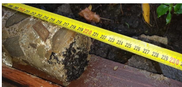
Viditelný asfaltový nátěr rubu opěry.
