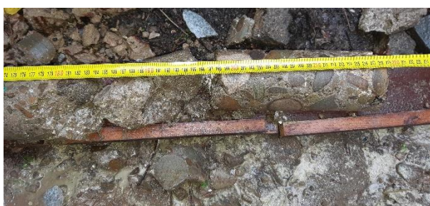
190-220 cm, beton opěry, konec opěry (rub),
