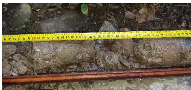
90-120 cm, beton opěry,
