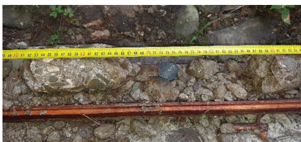
60-90 cm, beton opěry proměnlivé pevnosti,
