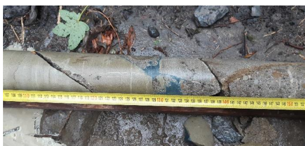
110-150 cm, pískovcový kámen, viditelný spojovací ložný beton,
