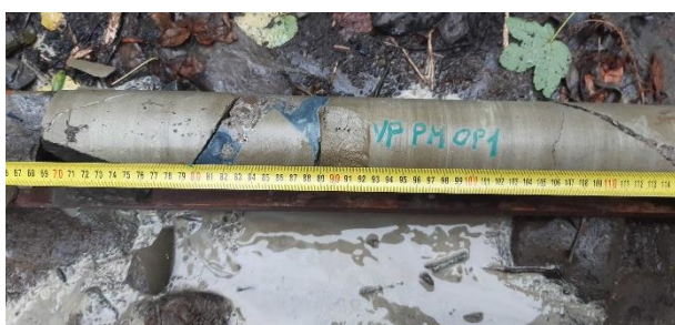
60-110 cm, pískovcový kámen, viditelný spojovací ložný beton,
