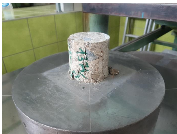
Pohled na porušený vzorek betonu opěry 1374/25 při hodnotě krychelné pevnosti 19,1 MPa.
