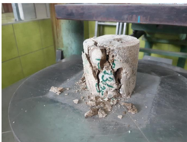
Pohled na porušený vzorek betonu opěry 1373/25 při hodnotě krychelné pevnosti 10,7 MPa.
