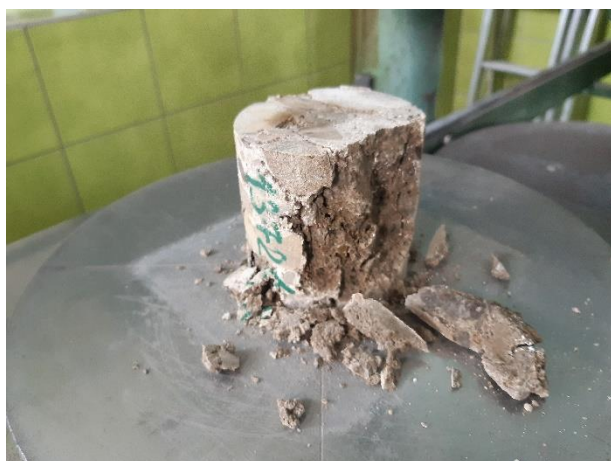
Pohled na porušený vzorek betonu opěry 1372/25 při hodnotě krychelné pevnosti 15,4 MPa.
