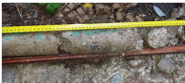
150-190 cm, beton opěry,
